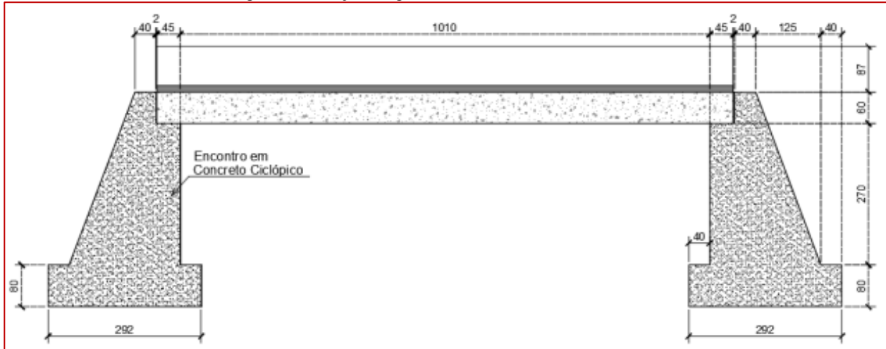
Figura 11 – Seção longitudinal do tabuleiro (cotas em cm).
